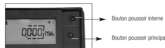
Sélectionner le paramètre à ajuster, BP principal et appuyer sur le bouton interne plus de 2 secondes. Le chiffre clignotant peut alors être changé en utilisant le BP principal. Une action sur le BP interne permet de passer à la valeur suivante ci-contre
