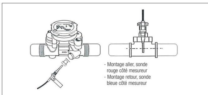
Plomber les raccords filetés (C4) ainsi que le bouchon de la sonde externe. Orienter l'intégrateur afin que la lecture s'effectue aisément.
